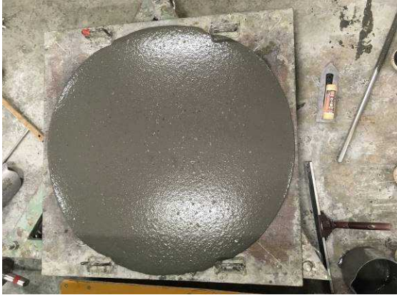
ジオポリマーのフロー状況
