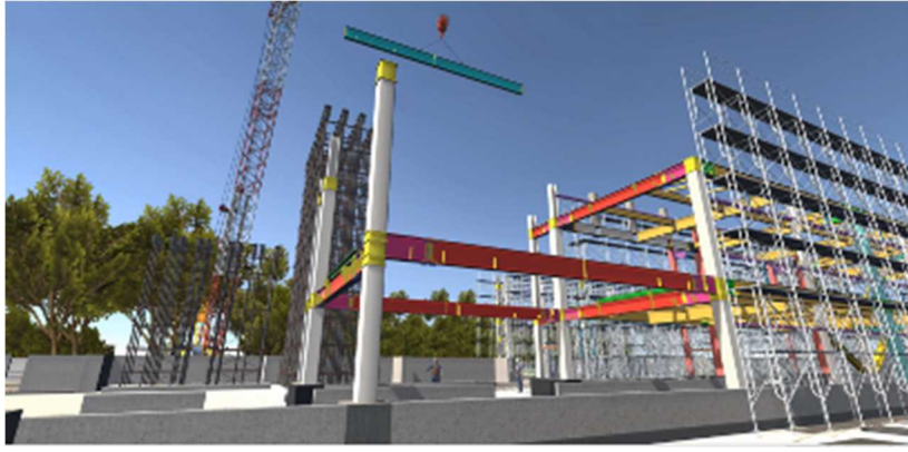
4D 施工シミュレーション
