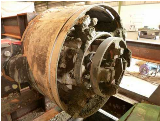
カッターの前方突出量変更バリエーション
