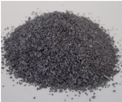
①使用する鉄粉の外観写真
