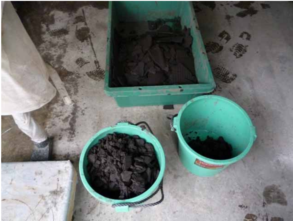
図9：水熱爆砕処理によって浄化された土壌(濾過脱水後の脱水ケーキ)
