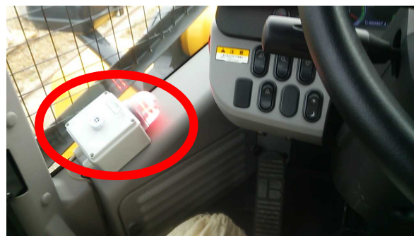
人との接触の危険がある場合のみ、モニター(左)に警告が表示 同時に警告灯(右)が作動し、警報音が鳴ります
