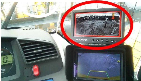
人との接触の危険がある場合のみ、モニター(左)に警告が表示 同時に警告灯(右)が作動し、警報音が鳴ります
