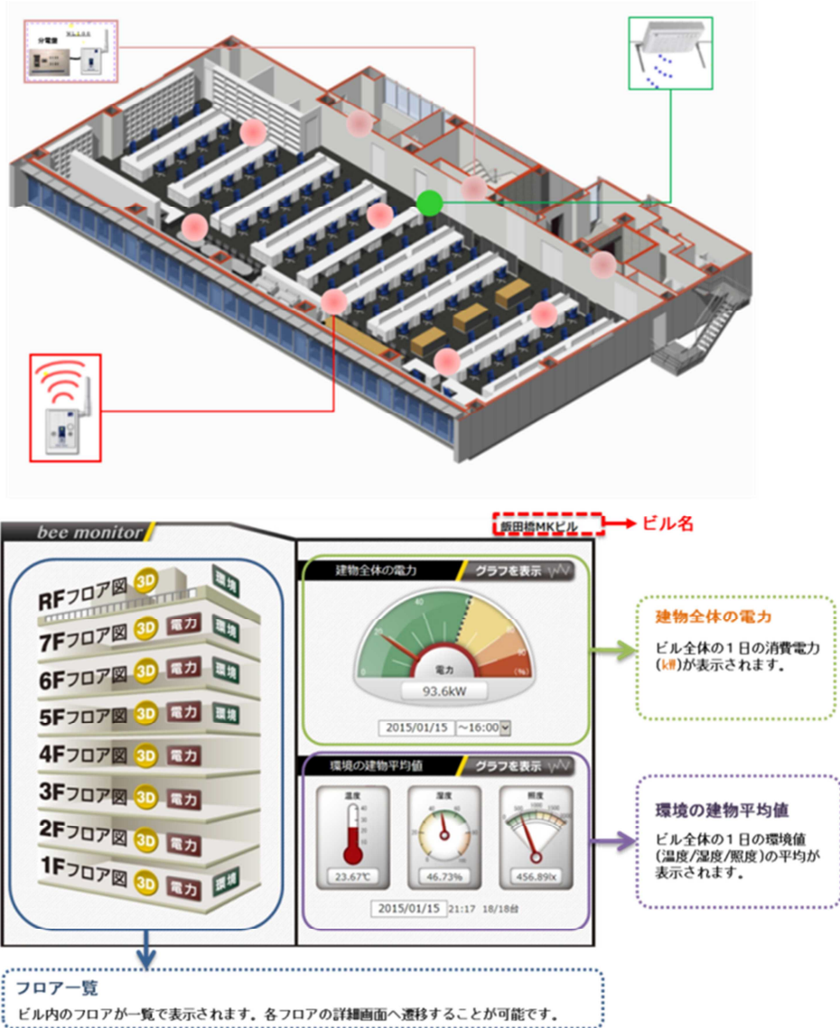
図-3 「bee-monitor」(電力・温湿度・照度計測システム) 概要図
