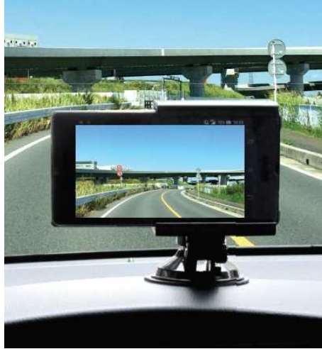
図—1 システム車載器装着状況
