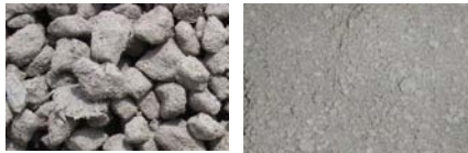
写真-2 再生骨材(左:粗骨材,右:細骨材)
