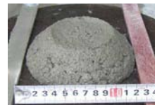
写真-3 再生細骨材を用いた吹付けモルタル
