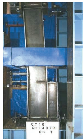
写真-1 梁部材実験 載荷状況
