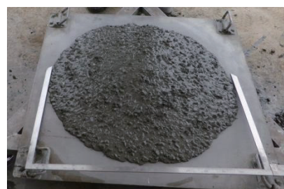
写真-1 フレッシュコンクリートのスランプフローの状況
