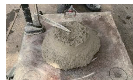
写真-1 低炭素型のコンクリートのスランプ試験
