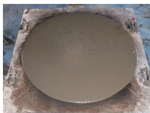
写真-1 ジオポリマー施工状況（左から、スランブフロー状況，打込み状況，押さえ状況，打込み完了状況）
