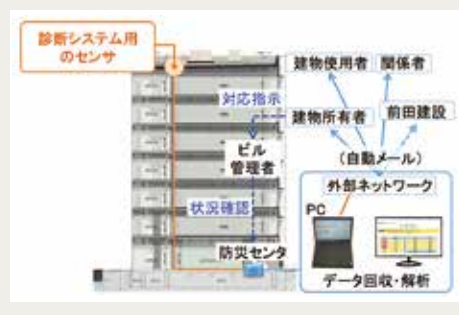
建物の安全性即時診断システムのしくみ
