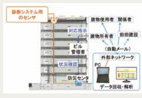
建物の安全性即時診断システムのしくみ
