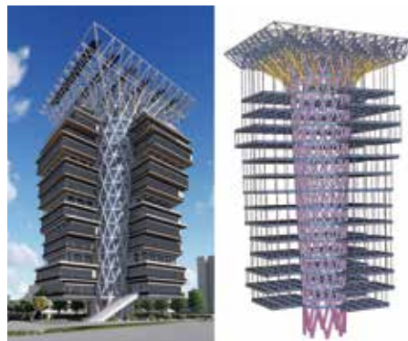
VPLを活用したプログラミングによる吹き抜けデザイン
