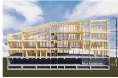
木軸断架構モデル(仙川桐朋学園作業所)
