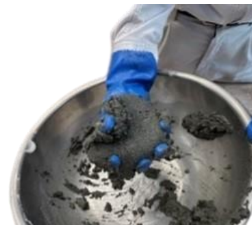
写真-3 チャンバ内泥土の例
