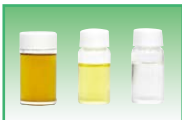
収集時の 廃油 一般的な 精製状態 今回使用の 蒸留状態
