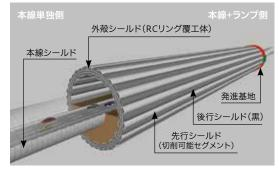
CS-SC工法の概要図
