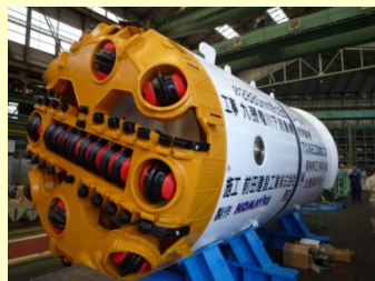
φ2,880mm泥土圧式 シールドマシン
