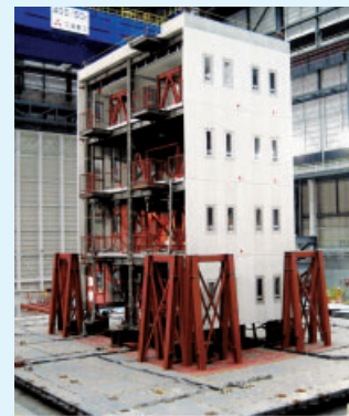
破壊試験（S造4階建）
