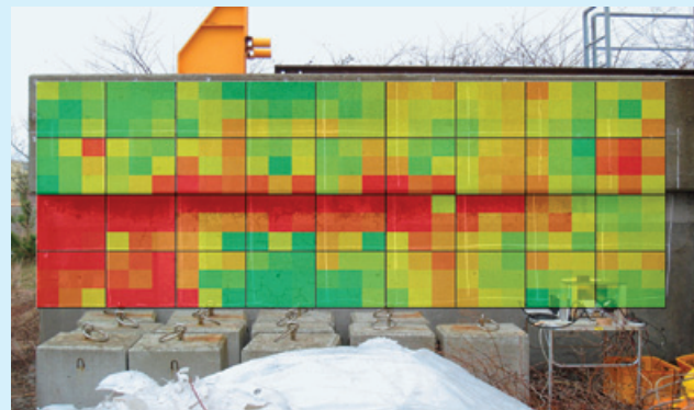
コンクリート表面塩分量のマッピングの例
