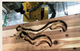
恐竜骨格標本の部材の切削状況
