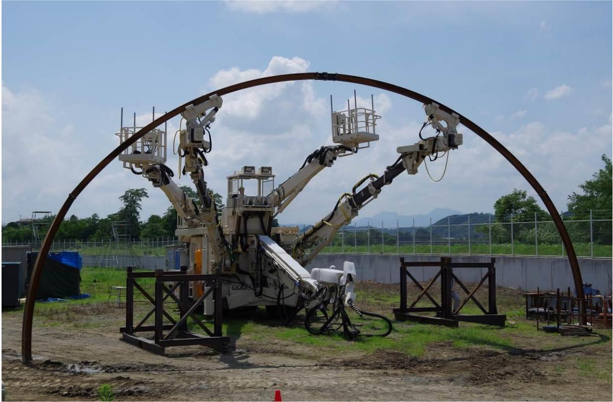
鋼製支保工建込みロボット全景
