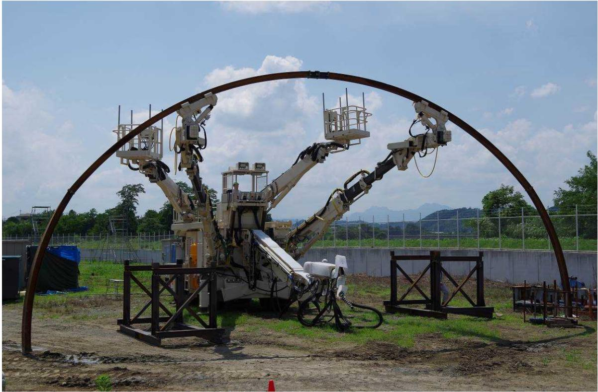
図1 鋼製支保工建込みロボットの全景
