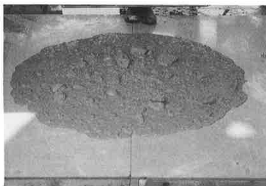
写真-1 V_g390 の大型フロー ( 121\text{cm} )
