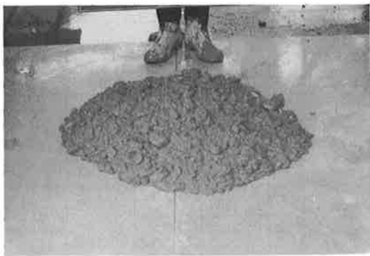
写真-2 V_g470 の大型フロー ( 100\text{cm} )
