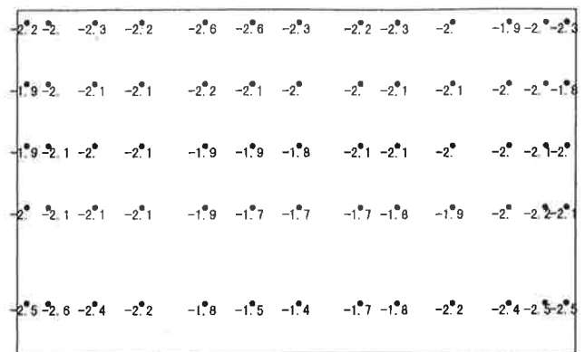
図 4.6 直方体建物に作用する負のピーク風圧係数 (36 風向中の最大値)
