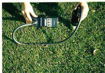
写真-3 色彩色差計による測定状況
