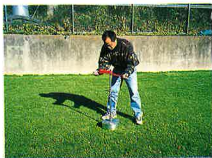
写真-8 牽引力の測定状況
