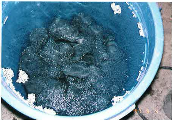
写真-2 水面の状況（礫状モルタル工法）
