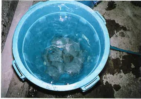
写真-1 水面の状況（袋詰め投入工法）
