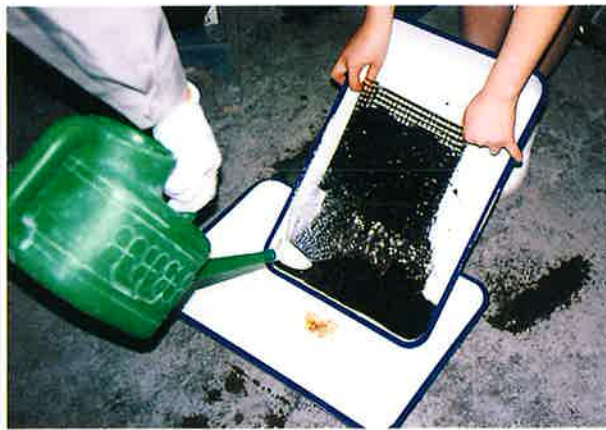
写真1 基材流出試験実験風景
