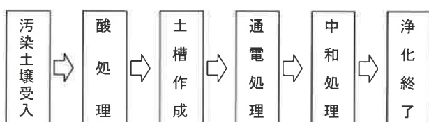
図- 14 本法による浄化処理フロー
