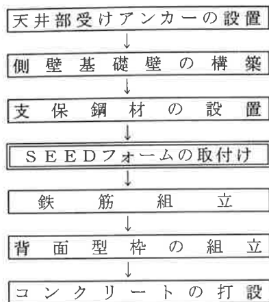
図-10 中壁部の施工フロー
