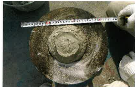
写真-2 フロー試験（15 回落下後）
