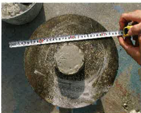
写真-1 フロー試験（コーン引抜き直後）
