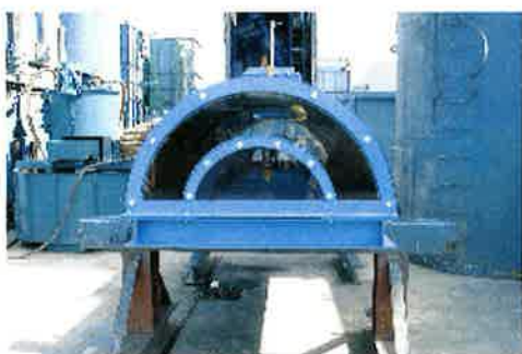
写真-3 模型型枠外観
