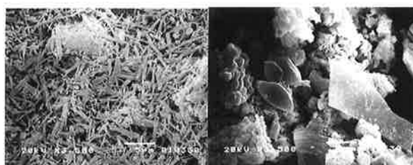
(加熱前) (加熱6日後) 写真-2 一般灰のSEM写真 (×3500倍)
