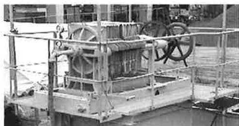
写真-9 実験に使用したフィルタープレス
