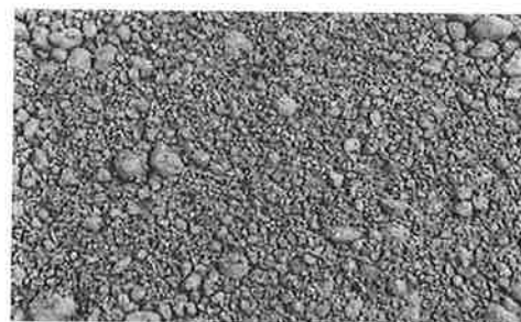
写真-13 脱水土に土質改良助材(4kg/m 3 ), 中性改良材(5kg/m 3 )を添加した状況
