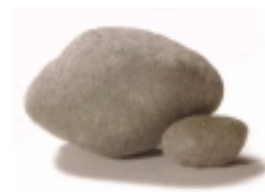
(a) 外観 (b) 骨材粒 写真-1 高性能軽量骨材(中国製)
