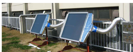
写真 1 集熱特性実験風景
