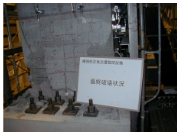
写真-1 終局時の試験体の損傷状況
