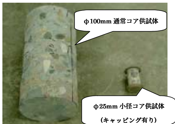
写真-1 採取コア供試体の状況
