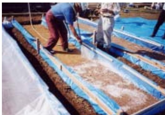
写真 - 1 液状マルチング散布状況
