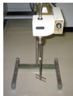
写真-1 攪拌装置
