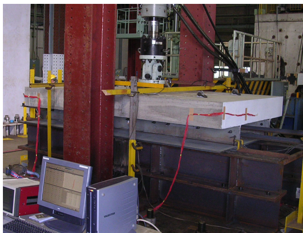
写真-2 定点疲労載荷試験の載荷状況
