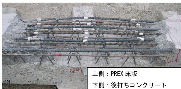
写真-8 梁疲労試験後の鉄筋はつり状況
