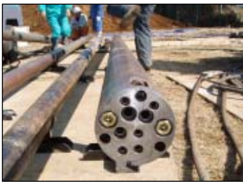
図-5 造成ロッド(φ140mm 多孔管)
