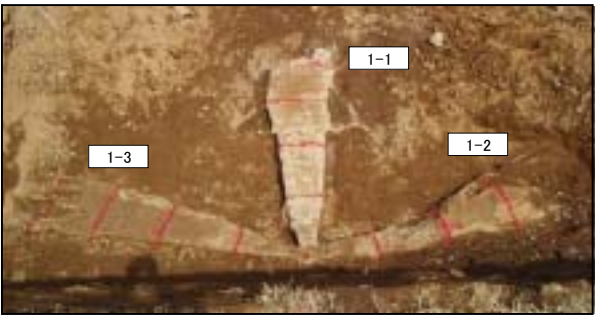
図-15 ケース 1-1～1-3 改良径確認
