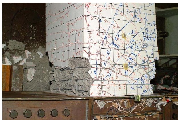
図-18 柱脚部の破壊状況(载荷終了時)
