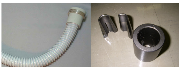
写真-6 左：フレキシブルホース、右：ウェッジ
