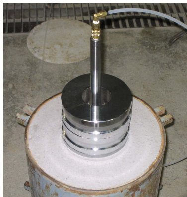
写真-2 迅速透水試験装置を用いた注水試験状況
