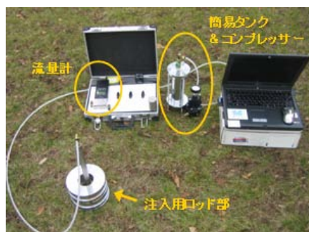
写真-1 迅速透水試験装置
