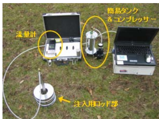
写真-1 迅速透水試験装置と使用状況
