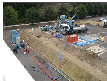
実規模圧送実験（500m）
