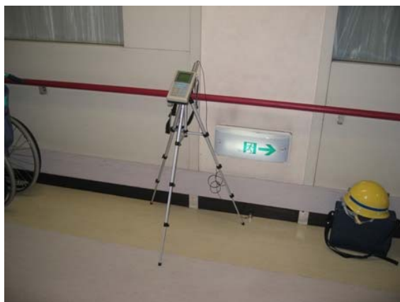
(b) 振動測定(スラブの柱際にセンサ設置) 写真-1 施工および測定状況(現場 A)
