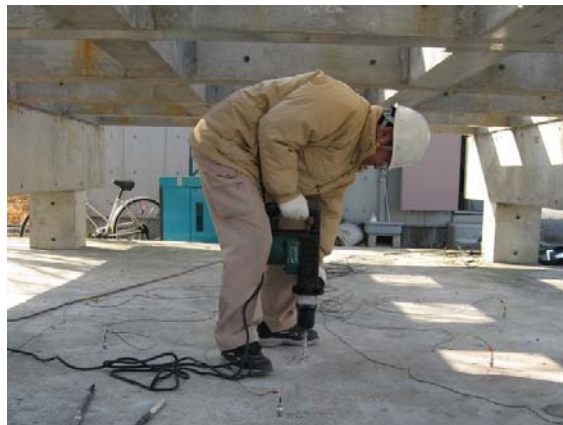
(b) ハンマドリル B による加振(穿孔)
