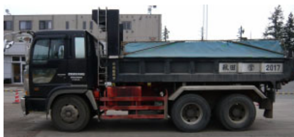
写真-1 衝撃加振源（ダンプトラック）
